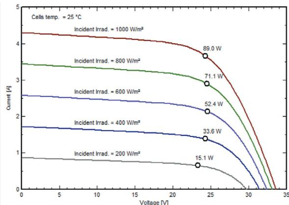
Corrente (A) vs. Vtaggio (V) confrontati con vari livelli di irraggiamento.
